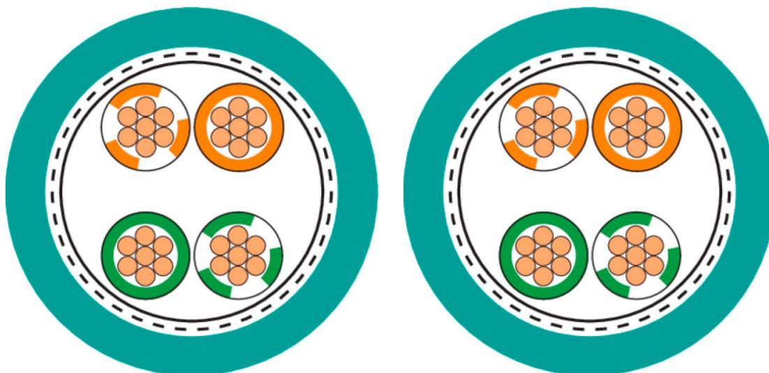
LAPP KABEL STUTTGART ETHERLINE® Y Flex CAT.5e 4x2xAWG20/7
