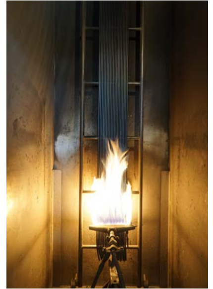
Ensayo de fuego vertical y no propagador del incendio (CSA FT4; UL Ensayo vertical).
